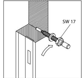
2. Unterlegscheibe auf Spezialschraube aufstecken. Spezialschraube festdrehen.
