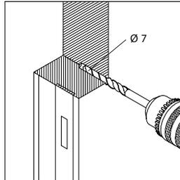
1. Von der Griffseite mit 7 mm Bohrer vorbohren.
