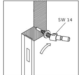
2. Unterlegscheibe auf Spezialschraube aufstecken. Spezialschraube festdrehen und ausrichten.
